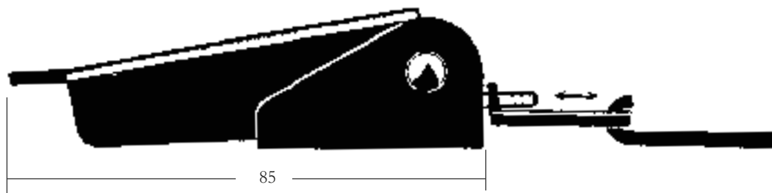
Ref. C1033 Cierre con tensión regulable. El mecanismo y el enganche quedan ocultos por el cuerpo del mismo
